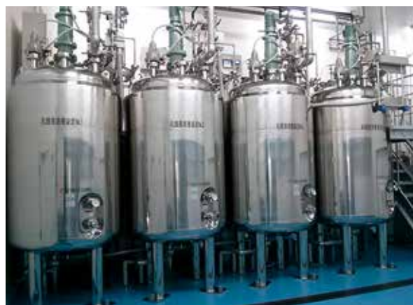
液体培養装置（ジャーファーマンター）
